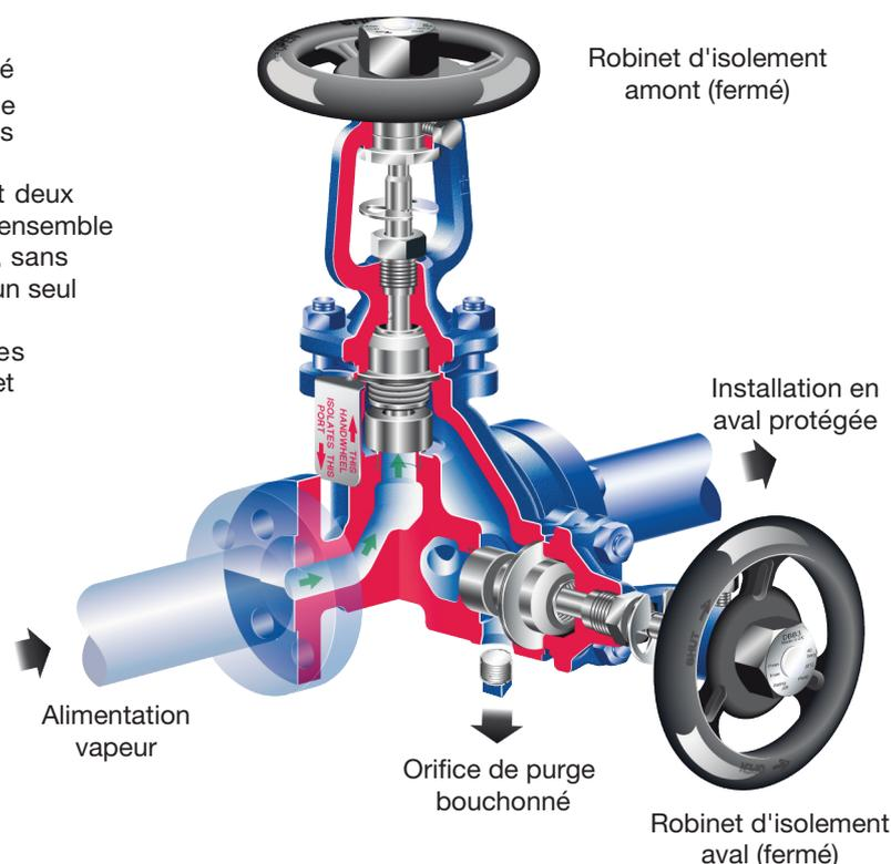
Le robinet jumelé à soupape avec soufflet d'étanchéité peut être utilisé sur une large variété d'applications comme la vapeur et les condensats, les process de liquides, les réseaux d'eaux chaudes et d'eaux froides, d'air comprimé et des installations de fluides thermiques. Le robinet DBB3 est disponible avec le corps et le chapeau en acier carbone, du DN15 au DN100 avec des raccords à brides PN40 et ANSI 300.
