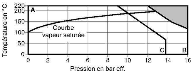
Cet appareil ne doit pas être utilisé dans la zone ombrée.
