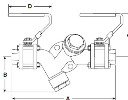
STS17.2 version avec robinet d'isolement double en amont
