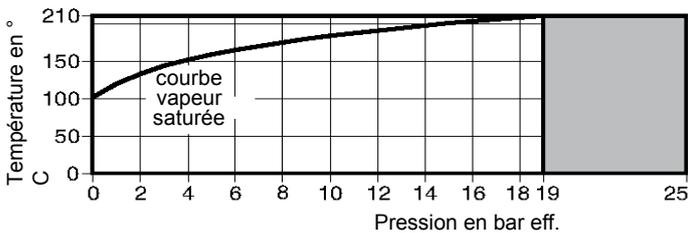
Cet appareil ne doit pas être utilisé dans la zone ombrée.
