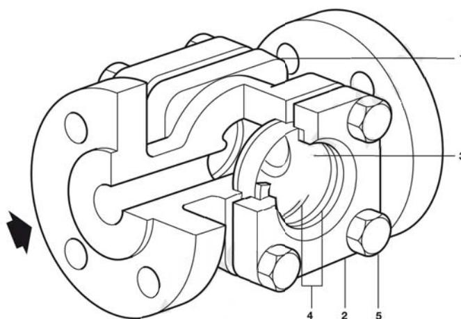
**Noter** que les brides sont soudées sur le corps des DN15 à DN25
