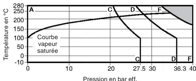
Cet appareil ne doit pas être utilisé dans la zone ombrée.
