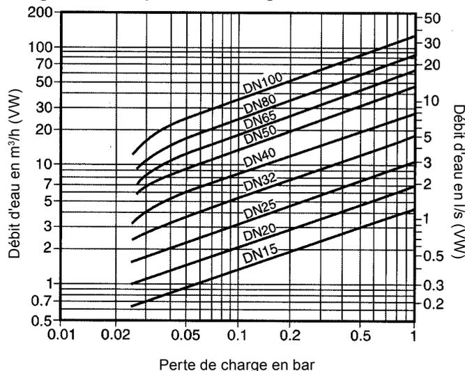
Diagramme de perte de charge avec disque ouvert et de l'eau à 20°C. Les valeurs données sont valables pour des clapets équipés de ressort avec un sens d'écoulement horizontal. Avec le sens d'écoulement vertical, des variations insignifiantes surviennent seulement à l'intérieur de la plage d'ouverture partielle.
