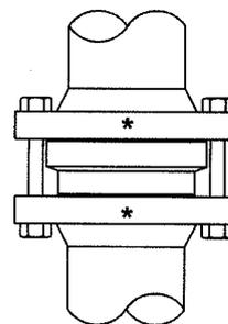
\*Nota : les brides, les boulons (ou goujons), les écrous et les joints sont fournis par l'installateur. Les clapets à disque sont indémontables (aucune pièce de rechange n'est disponible). Ils ne sont pas conçus pour une utilisation où le fluide est propulsé violemment, tel que par exemple proche d'un compresseur.
