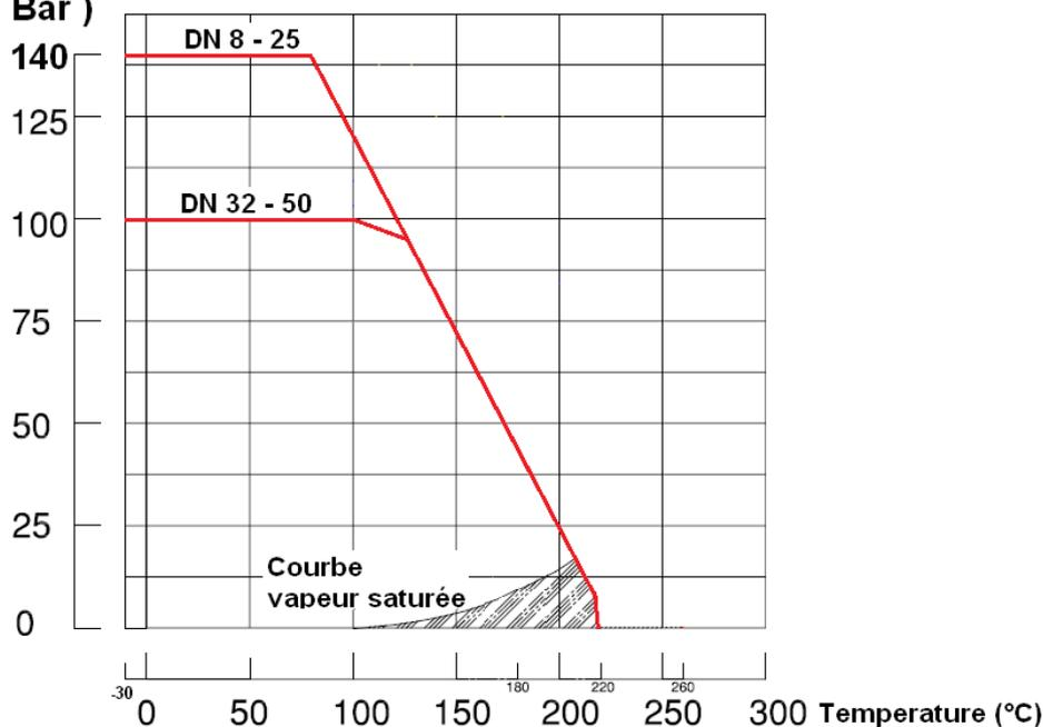
**COURBE PRESSION / TEMPERATURE AVEC OPTION JOINTS DE SIEGE PEEK :**
