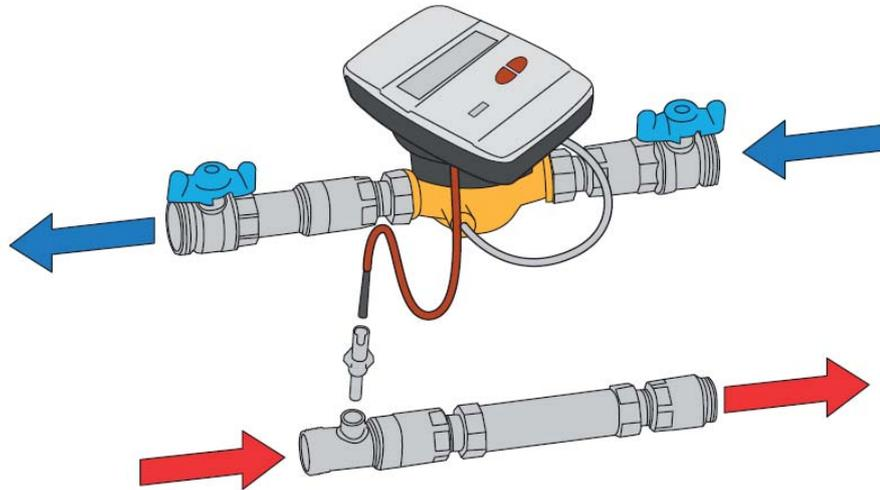
Une sonde mesure la température de l'eau chaude entrante ( généralement en sortie de chaudière ) , une autre la température de l'eau sortante, le compteur mesure le volume d'eau consommé, ensuite le module électronique calcul la différence de température relevée par les 2 sondes et indique la consommation d'énergie correspondante en kWh.
