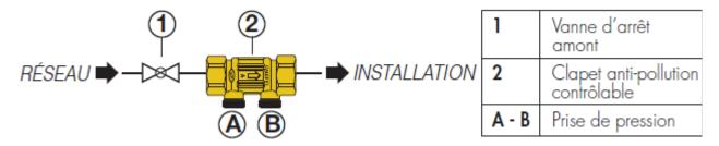
Avant d'installer le clapet anti-pollution, nettoyer la tuyauterie des impuretés à l'aide d'un jet d'eau de grand débit. Un mauvais rinçage du circuit peut compromettre le fonctionnement du produit.
