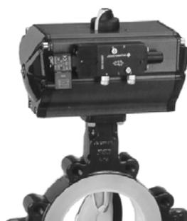
Un distributeur à pilotage électrique ou pneumatique à embase NAMUR peut être fixé en applique directement sur le plan de pose situé sur le coté de l'actionneur.
