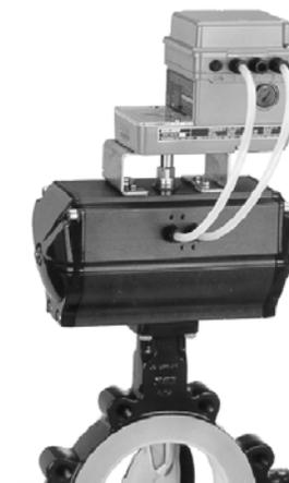
Un positionneur à signal pneumatique 3-15 PSI ou à signal électrique 4-20 mA (standard ou à sécurité intrinsèque) peut être installé sur l'actionneur par l'intermédiaire d'une arcade avec interface NAMUR suivant VDI/VDE 3845.
