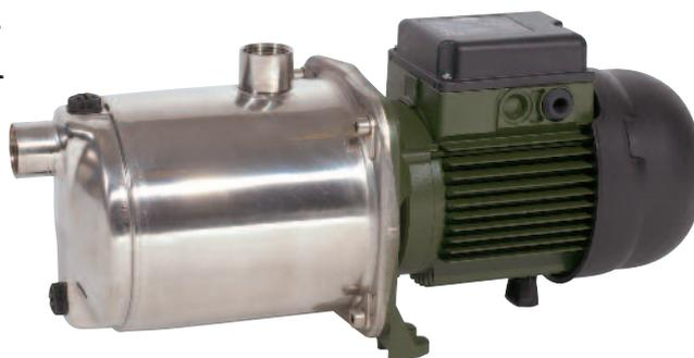
**Pompe centrifuge multicellulaire** auto-amorçante à axe horizontal, très silencieuse, adaptée pour l'alimentation hydraulique et la surpression dans des installations domestiques, pour l'arrosage et le jardinage, le transfert d'eau en général.
