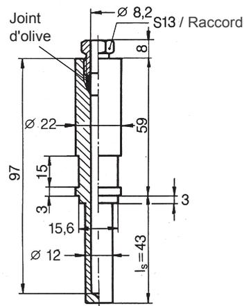
Exécution pour tuyauteries calorifugées et thermomètres avec profondeur de plongée min. < 60 mm
