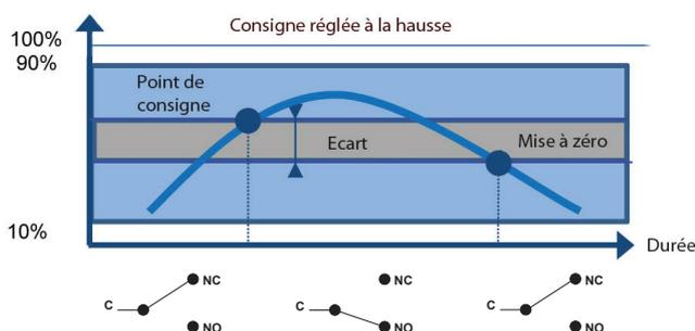
Un élément sensible déformable actionne un microrupteur par l'intermédiaire d'un piston. Le réglage de la consigne est obtenu par un ressort comprimable monté en opposition.
